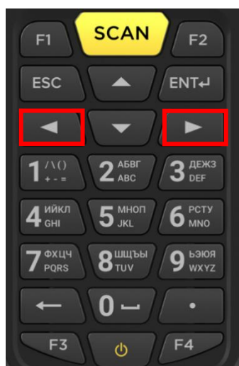
Рисунок 34. Клавиатура устройства (навигационные клавиши выделены красной рамкой)
